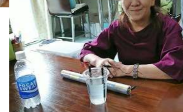
★カップの中の鉛筆の先からポコポコ泡が出ます。（+極 酸素 ー極 水素）
